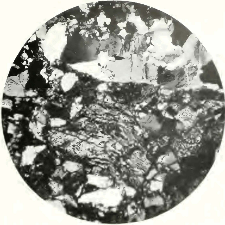
Fig. 5. (23) bei Vergr. 35:1. Die Mikrophotographie zeigt gequetschte Feldspatkörner wie auch Fragmente eines Granitmylonits. + Nicols.
